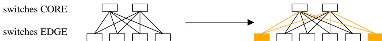
Figure 11 - Exemple d'évolution d'une architecture core-edge dual core
